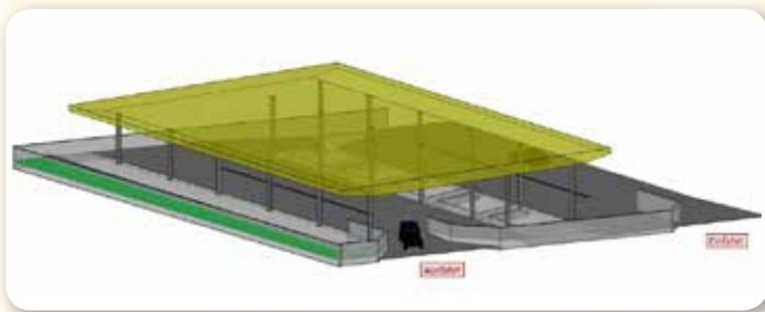
Im Zuge der umfassenden Um- und Ausbauarbeiten wird das Areal großzügig überdacht und die Container und Verkehrsflächen so angeordnet, dass die Abgabe von den verschiedenen Abfällen erleichtert wird. Um ein gerechtes Erfassungssystem zu gewährleisten wird ein elektronisches Zutrittssystem eingerichtet.
